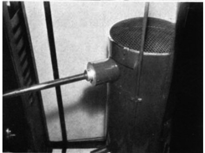
図1. [訳注] 原文にはこの写真の説明がないが、左図は装置全貌で、寝台上にある黒い筒の内部に管球があり、下面の小突出部が照射口、これが寝台の頭部、足部に回転軸を持つゆりかご上の架台に載っており、架台が寝台周囲を半周回転する。上部の2本の線は電源ケーブル。右上図は、寝台を開けたところで、本文中でベアリングと説明されている架台の回転軸と軸受けの部分、右下図はこれを駆動するモーターを示したものと思われる。
