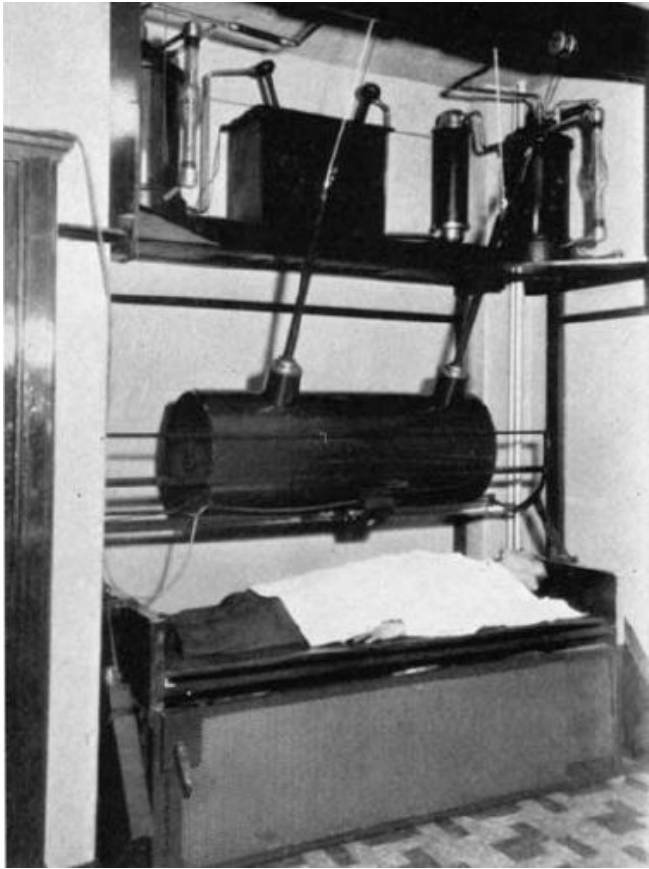
図1. [訳注] 原文にはこの写真の説明がないが、左図は装置全貌で、寝台上にある黒い筒の内部に管球があり、下面の小突出部が照射口、これが寝台の頭部、足部に回転軸を持つゆりかご上の架台に載っており、架台が寝台周囲を半周回転する。上部の2本の線は電源ケーブル。右上図は、寝台を開けたところで、本文中でベアリングと説明されている架台の回転軸と軸受けの部分、右下図はこれを駆動するモーターを示したものと思われる。
