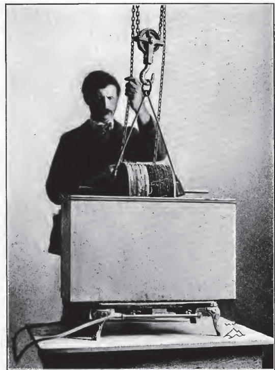
図 71-15. 交換可能二次セクションを持つ誘導コイルのセクションの液浸.
