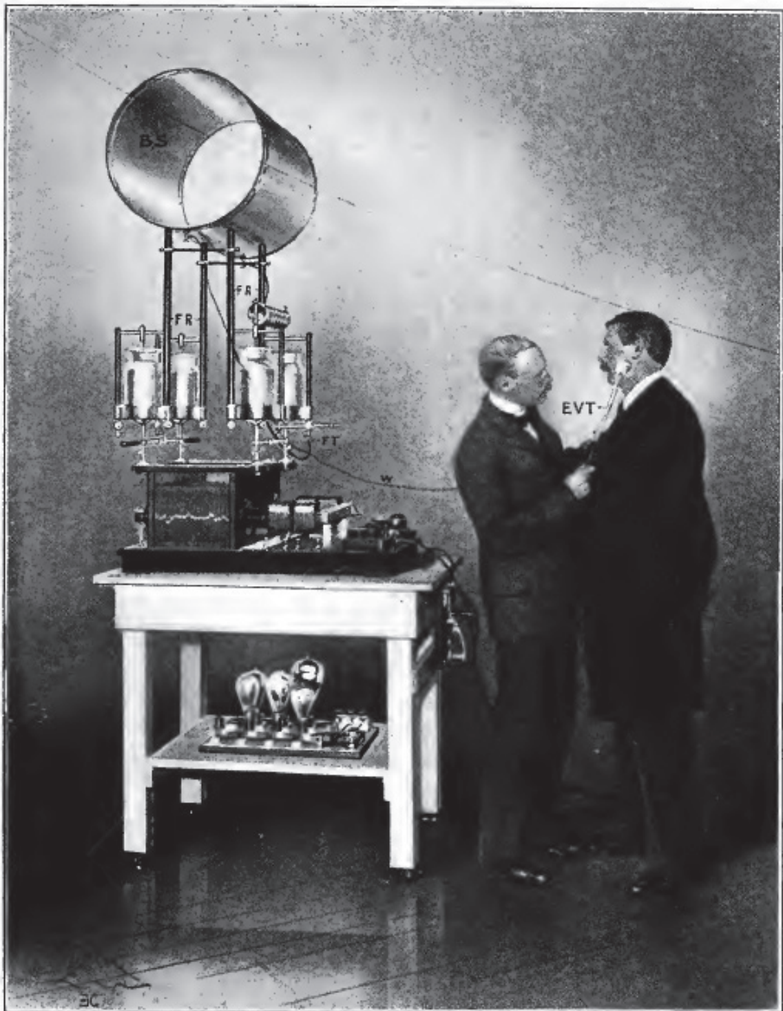
図 150-13. ヒンジ付きファラデーリングでX線管電極を励起する方法. ソレノイドBSは、ファイバーロッドFRによって支持され、絶縁されており、一端はファラデーリングの二次側FTに接続される。他端は、ワイヤWに接続され、これは電極真空管EVTに金属接続されている。閉じたファラデーリングの二次側の1つの電極だけが真空電極に接続されているため、電流は患者を出た後、電線ではなくエーテルを介して発電機に戻る。このような状況で、部屋が暗い場合、発電機はオーロラのような外観を呈することがある。患者に適用されるエネルギー強度を調整する最も簡単な方法は、段階的な抵抗によりファラデーリングの一次側の電流を変えることである。ソレノイドは図に示す位置から取り外し、床または他の便利な位置に置くことができる。ソレノイドはさまざまなサイズが用意されており、フランス方式で使用する。患者の全体または一部をソレノイドに囲まれた状態と、両電極をファラデーリングの二次側の電極に接続する。
