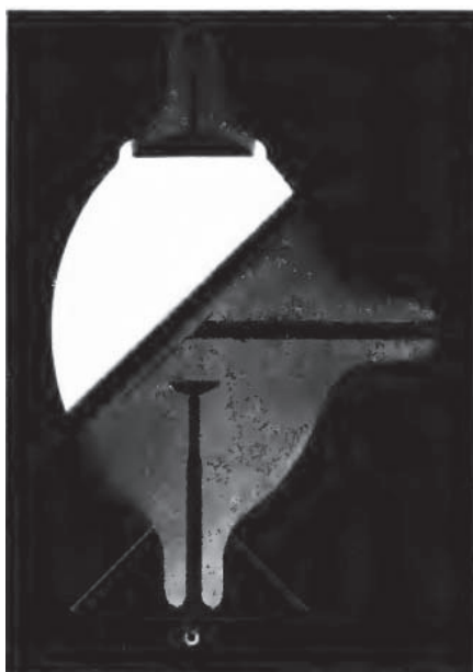
図 22-49. ガードル (環状暗帯) が認められる陰極と陽極の間にターゲットをもつ X線管.
