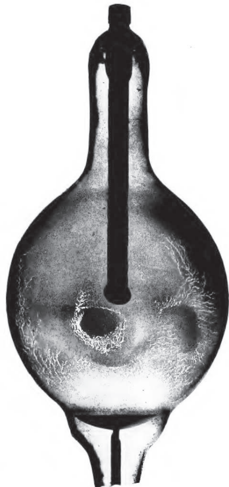
図 18-44. 陽極流の影響を示す冷却ターゲット X 線管
