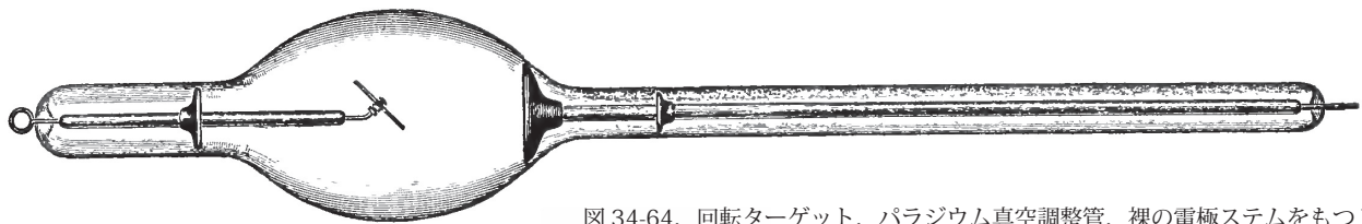
図 34-64. 回転ターゲット, パラジウム真調整管, 裸の電極ステムをもつ X線管
