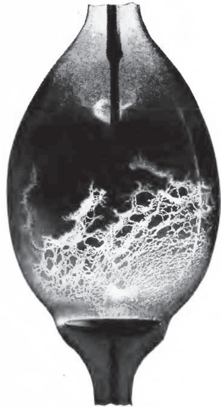
図 17-45. 発電機との不調和の影響を示す X 線管
