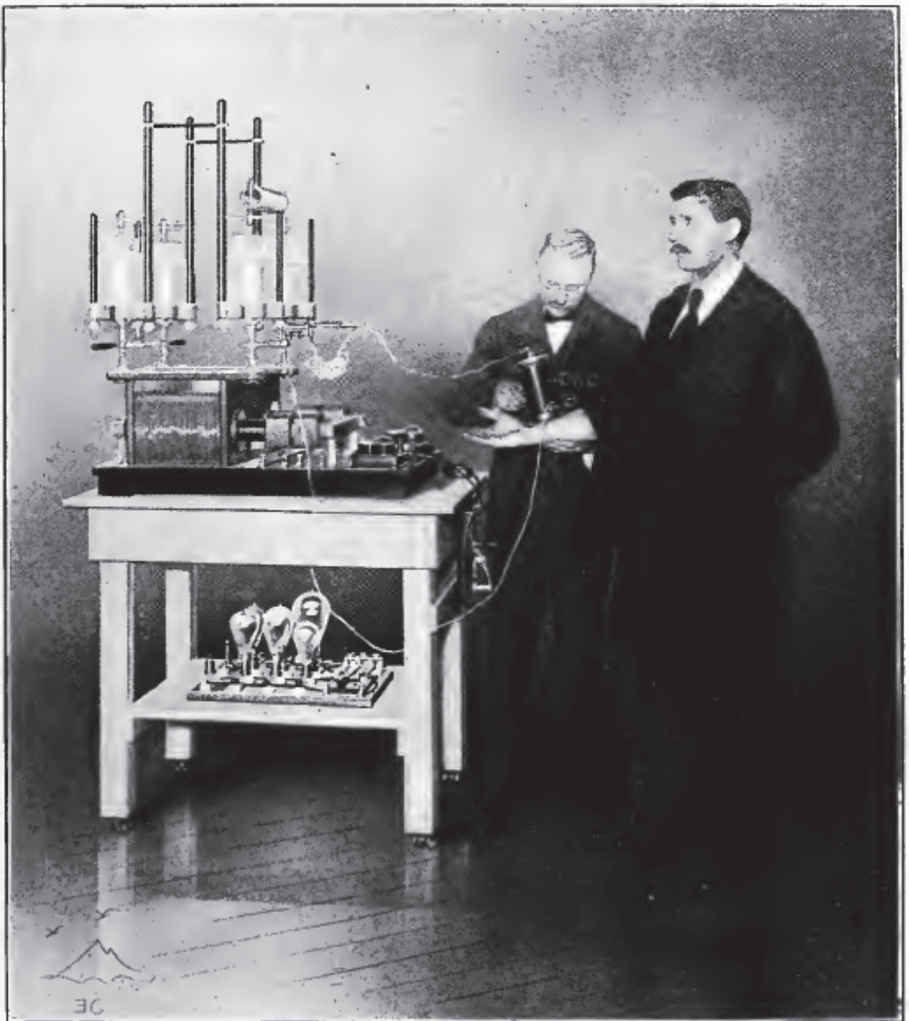
図 149-12. デルマ線管の使用方法. 閉じたファラデー リングから伸びる電線を, FT の二次側の端子に接続し, 他端はバインディングポスト B によってデルマ線管の電極に接続する. デルマ線管のケース DRC は, 放射線非透過性材質で厚くコーティングされており, ケースを持つ手は放射線非透過性手袋で覆っている.
