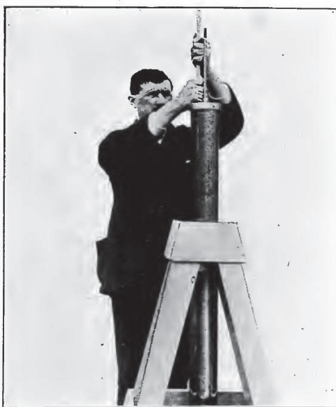
図 63-5. 鉄製ワイヤコアのパッキング法.
