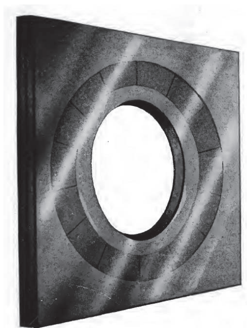
図 74-19. 交換可能二次セクションを持つ誘導コイルの完成したセクション.
